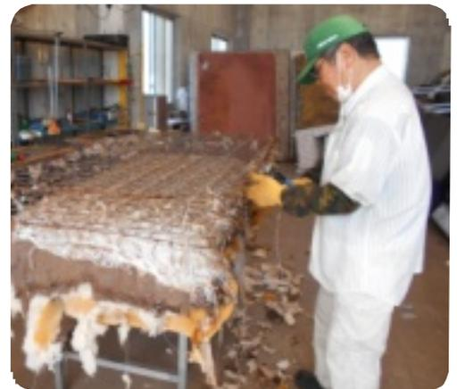
1階の粗大ごみストックヤードでは家具など解体作業を手作業で行う。この日は、ベッドの解体作業でスプリングと布等を切り離して分別を行う
