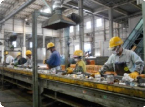
沖縄市をはじめ宜野湾市、北谷町から回収されたごみのうち、ビン類の資源ごみは1階のベルトコンベア上でビンの色分け作業から開始
