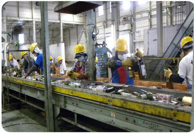
燃えるごみ・不燃物・粗大ごみ・資源ごみは1日約220tが沖縄市、宜野湾市、北谷町から回収されるという。ここでは、回収されたビンの栓抜き、ビンの色分け作業が行われる。
