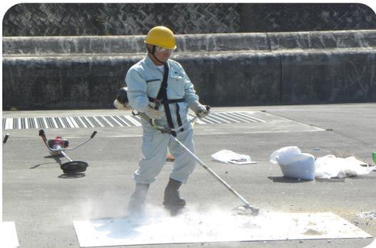
小石、砂利の飛散距離の検証では、14~17mの飛距離。大きな事故に繋がる危険性が実証された。
